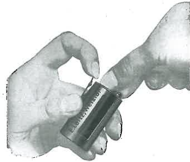
Fig. 8. Wie man die Kassette B öffnet.
